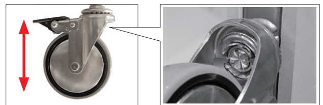
キャスター前輪のストッパーツマミを下方へ倒すと車輪・車軸にロックがかかります。
