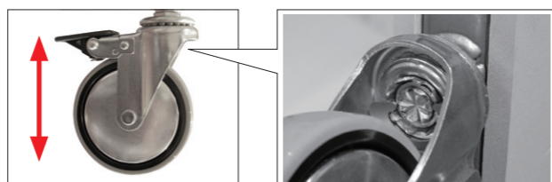
キャスター前輪のストッパーつまみを下方向へ倒すと車輪・車軸にロックがかかります。
