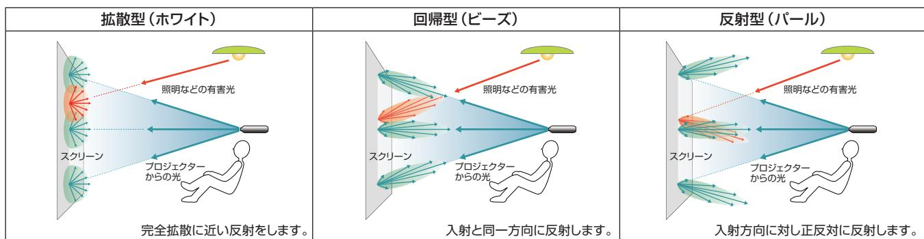
全方向に拡散反射するので視野角が広く、どの位置からでも同質の映像を見る事ができるため最も使用されているスクリーンです。ただし、有害光<sup>\*</sup>も同様に拡散するため、照明対策やプロジェクターの光出力に余裕がある事が要求されます。
