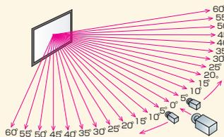
スクリーンサンプルの中心に垂直方向に光を照射し、中心から同一円弧上を左右60°の範囲で5°ずつ移動したポイントでの反射光の明るさを、輝度計で測定します。
