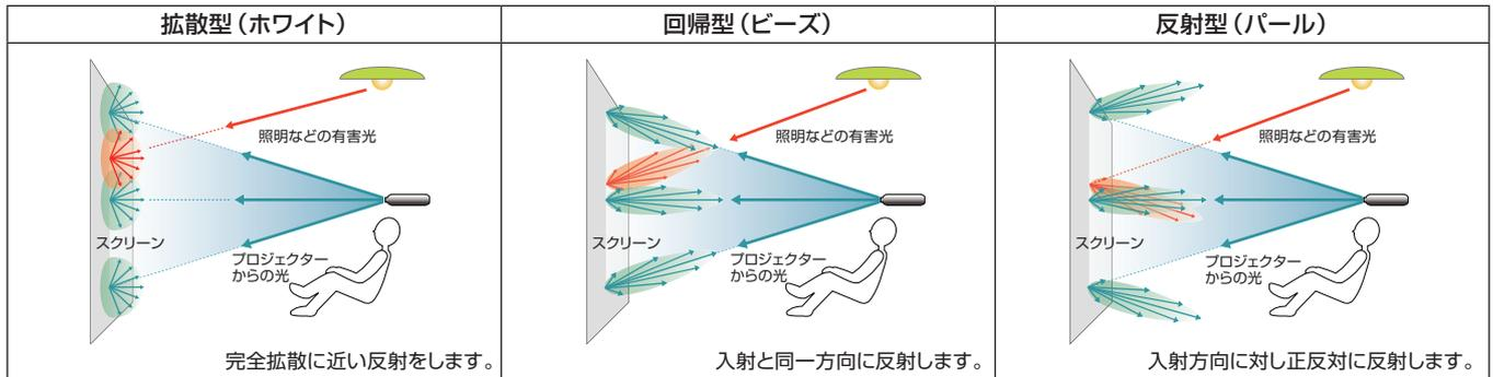
全方向に拡散反射するので視野角が広く、どの位置からでも同質の映像を見る事ができるため最も使用されているスクリーンです。ただし、有害光\*も同様に拡散するため、照明対策やプロジェクターの光出力に余裕がある事が要求されます。
