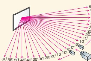
スクリーンサンプルの中心に垂直方向に光を照射し、中心から同一円弧上を左右60°の範囲で5°ずつ移動したポイントでの反射光の明るさを、輝度計で測定します。
