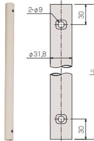
スラブ取付板 (KY-30R)、傾斜自在型スラブ取付板 (KY-30F) に取り付けしスクリーンハンガーの高さを決定します。
