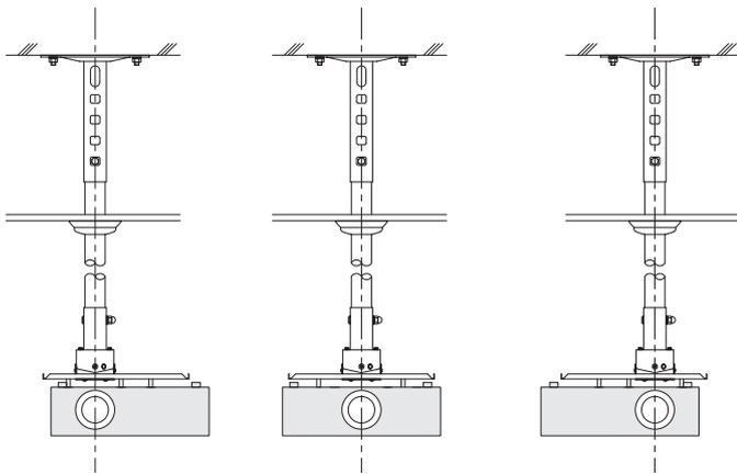
ご使用のプロジェクターの仕様に合わせて取り付け穴加工し出荷いたしますので、レンズ芯とパイプ芯を合わせることができます。
