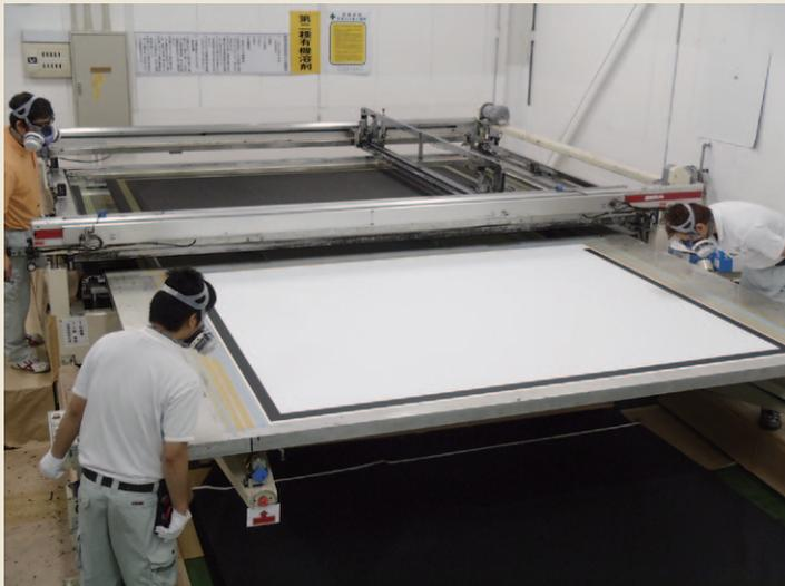
スクリーンの黒マスクは一般的に吹き付け塗装で加工されていますが、オーエスでは国内最大級のシルク印刷機による印刷を採用しているため、マスクラインのじみや曲がり大幅に軽減された、エッジの効いた仕上がりになります。塗膜の厚さも均一さに優れ、品質の安定と仕上がり美しさには定評があります。また、スクリーン生地材質に合わせた専用インキを使用することで対ブロッキング性、対剥離性に優れた高い品質を保証いたします。
