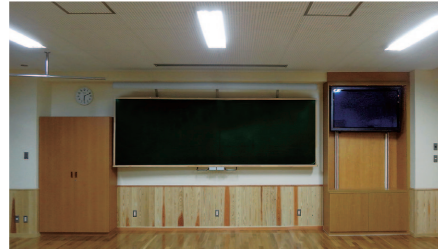
タッチパネルを使用するときには下げて、皆で見るときに上げる昇降機。静粛性と耐久性に優れた生地駆動を採用。
