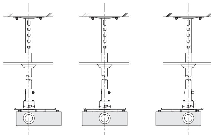
ご使用のプロジェクターの仕様に合わせ取り付け穴加工し出荷いたしますので、レンズ芯とパイプ芯を合わせることができます。
