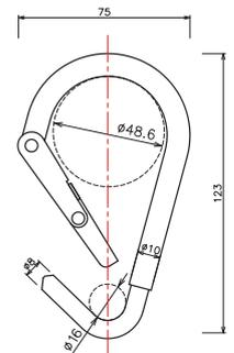
▲ゲートの中間を内側に折ることにより、ゲートを大きく開口し、大径のパイプが容易に入ります。一旦ゲートがしまれば、開口部が狭まり、矢印の爪を中に押さなければ、開口部は大きく開きません。
