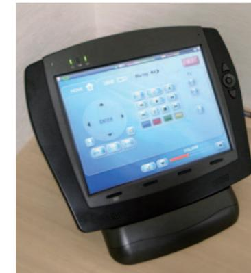
タッチパネルは写真左のような無線LAN対応のカラー表示タイプ、部屋の中であればどこにいてもコントロールが可能です。プロジェクターやスイッチャーなども各機材に応じた制御方法で対応できます。また、ワイヤレスタイプでなく写真右のような埋め込みタイプもご用意できます。
