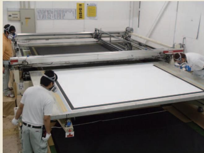
スクリーンの黒マスクは一般的に吹き付け塗装で加工されていますが、オーエスでは国内最大級のシルク印刷機による印刷を採用しているため、マスクラインのにじみや曲がり大幅に軽減された、エッジの効いた仕上がりになります。塗膜の厚さも均一さに優れ、品質の安定と仕上がりの美しさには定評があります。また、スクリーン生地材質に合わせた専用インキを使用することでブロッキング性、対剥離性に優れた高い品質を保証いたします。
