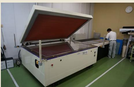
ソーラーセルを、耐候性に優れた保護シートでラミネート成型する装置。真空状態を作りシワや空気が入る事がないように、保護シートでソーラーセルと密着させて、熱溶着させます。
