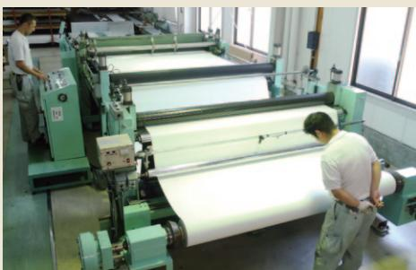
粗裁ち加工<sup>※1</sup>本裁ち加工<sup>※2</sup>は、自動裁断機を使用することで、正確に量産することが可能です。生地の検査工程を兼ねるため、大型照明を設置し検査環境の整備も行っています。
