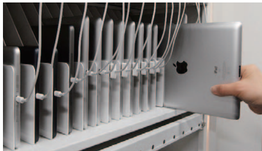
1段に20台のタブレットを保管。それぞれにACコンセントを装備。
