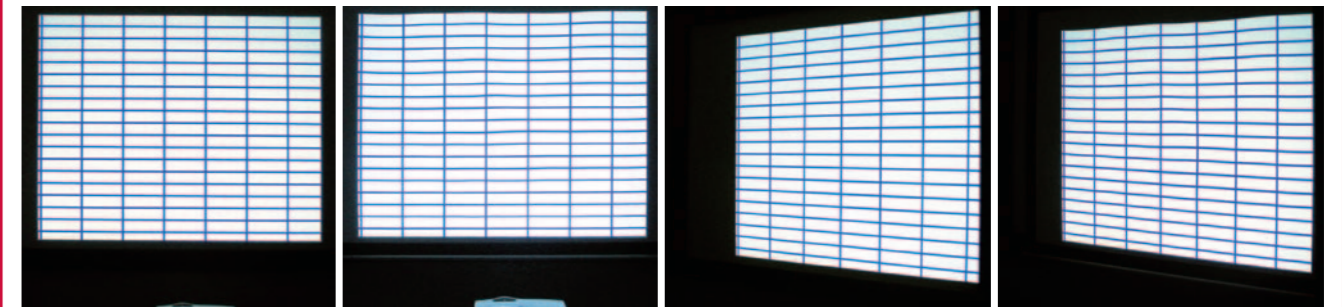
平面性の高いスクリーン (SZP) 一般的な巻取りスクリーン 平面性の高いスクリーン (SZP) 一般的な巻取りスクリーン
