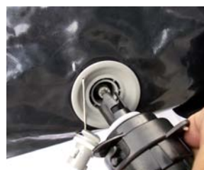
エアー注入口
