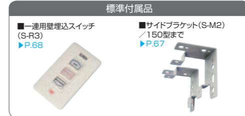
※壁埋込スイッチとスクリーン本体の接続は別途ケーブルをご用意ください。(0.75mm 2 ×4C×1相当品) サイドブラケット本体取付済。160型以上は本体一体型。
