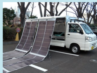
ソーラー浄水コンテナ
