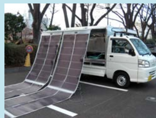
ソーラー浄水コンテナ
