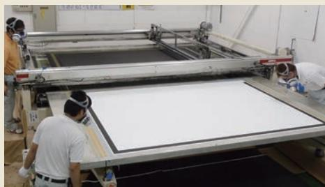
国内最大級のシルク印刷機で印刷されるスクリーンの黒マスクは、マスクラインのにじみや曲がりが大幅に軽減された、エッジの効いた仕上がりになります。塗膜の厚さも均一で、品質の安定と仕上がりの美しさには定評があります。
