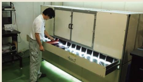
オーエスエムオリジナルの出力検査機は、製造されたソーラーシートが一定の光量において、基準の発電量が出力されている事を検査します。ソーラーシートは光量によって出力値が変化するため、一定の光量で出力値を測定することにより、良否判定を行います。
