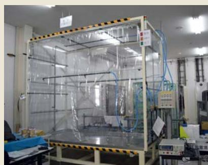
これまで、屋外で行っていた散水試験を屋内かつインラインで行えるよう、散水試験装置を自社設計しています。IP規格に沿った試験を全数行うことができ、検査プログラムは自動で進行する為、検査に要する工数の削減が実現できました。
