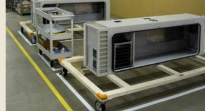
作業者の安全・作業性も考慮し、組み立て用台車等を自社設計しています。自社設計することでノウハウを蓄積し、他の生産工程への横展開を図る活動を行っています。
