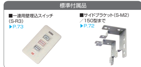
※壁埋込スイッチとスクリーン本体の接続は別途ケーブルをご用意ください。(0.75mm 2 ×4C×1相当品) サイドブラケット本体取付済。160型以上は本体一体型。
