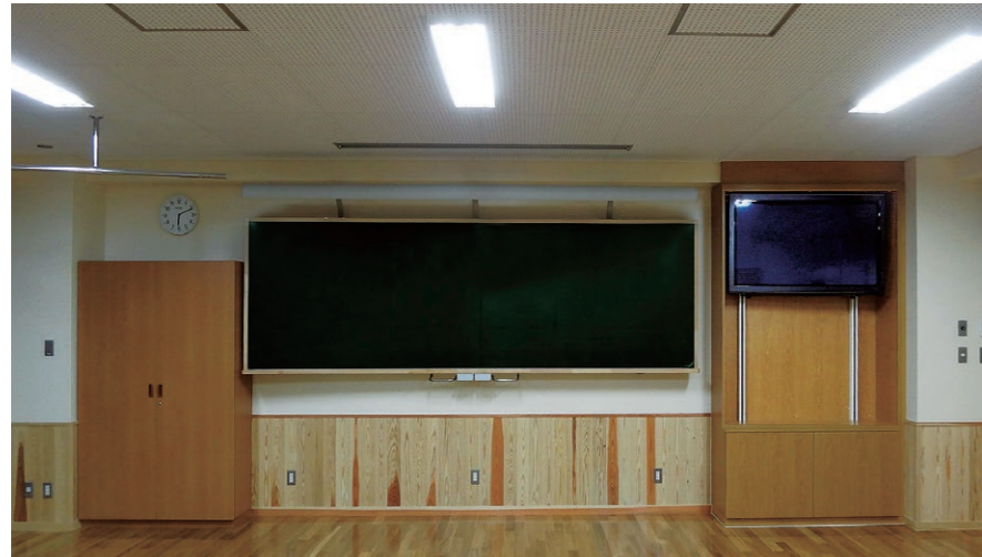
タッチパネルを使用するときには下げて、皆で見るときに上げる昇降機。静粛性と耐久性に優れた生地駆動を採用。
