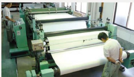
粗裁ち加工<sup>\*1</sup>、本裁ち加工<sup>\*2</sup>は、自動裁断機を使用することで、正確に量産することが可能です。生地の検査工程を兼ねるため、大型照明を設置し検査環境の整備も行っています。
