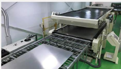
ソーラーセルを、耐候性に優れた保護シートでラミネート成型する装置。真空状態を作りシワや空気が入る事がないように、保護シートでソーラーセルと密着させて、熱溶着させます。
