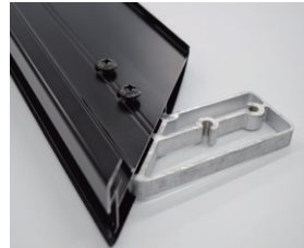
■ コーナー連結部 フレームのコーナー連結部は、ネジ4本で簡単に組立できます。
