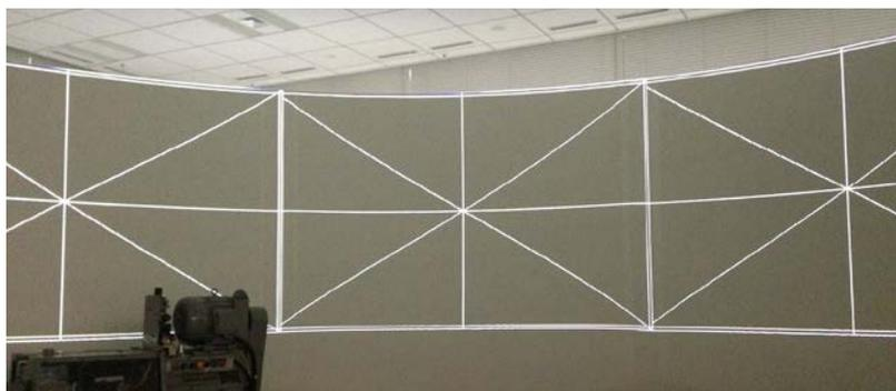
R壁に曲面補正とブレンド処理をして横幅10mの映像を投映。普段は待機映像が流れ、来客者がゾーンに入るとリモコンでコンテンツを再生します。その際には照明も連動します。また、新商品発表などのプレゼン用途も考え、持込PC映像を映し出すことも可能です。
