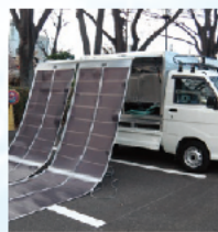
ソーラー浄水コンテナ
