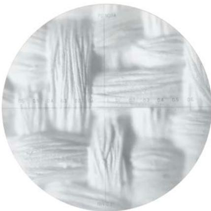
WF801の反射特性はお碗を伏せたような形で360°方向へ、同一の光量で映像を跳ね返す、拡散型の特性を持ちます。その為、スクリーンのどの位置からでも同質の映像を得ることが出来ます。その秘密は、ランダムに織られた特殊二重織構造です。
