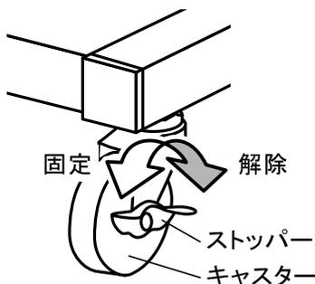
図1-2のように、キャスターのストッパーを固定側に倒すと車輪の回転が固定されます。
