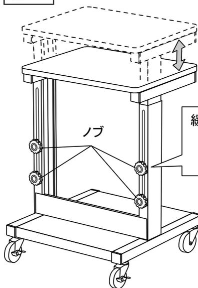
図1-3のように、左右4か所のノブを緩めることで上下に昇降できます。
