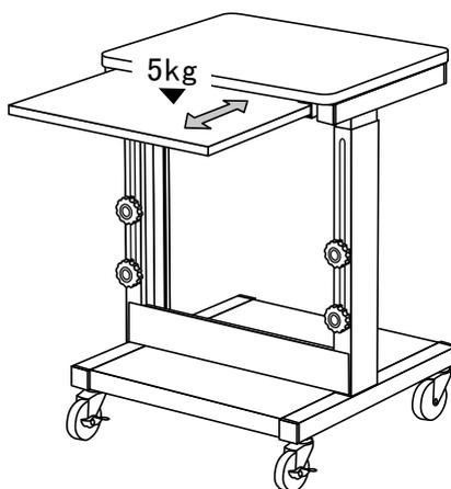
図1-4のように、スライド棚板を引き出して使用することができます。
