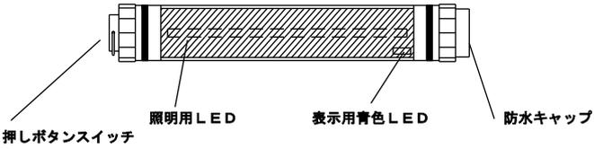
※押しボタンスイッチを押す度に、LEDのON・OFFや、点灯モードを切り替えることができます。またスイッチを2秒以上長押しでも、LEDをOFFする事ができます。
