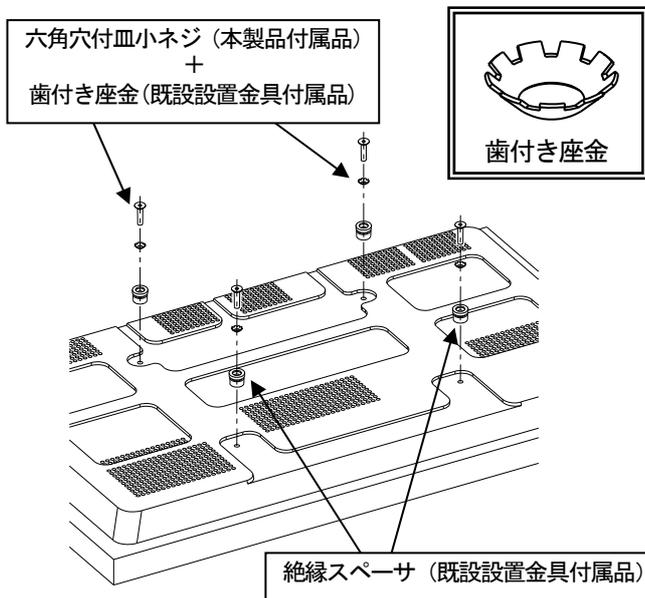
2. ディスプレイ背面に既設の設置金具付属の絶縁スペーサ(4個)と歯付き座金(4個)を本製品付属の六角穴付皿小ネジ(4本)にて取り付けます。
