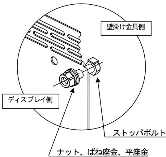
3. アタッチメントプレートの固定穴(φ12)に、付属のストップパボルト・平座金・ばね座金・ナットを手締めにて **軽く** 仮止めする。
