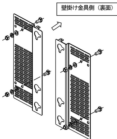
4. 同様に左右のアタッチメントプレートに上下1本ずつセットしてください。
