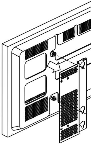
1. ボルトで固定させた左右のアタッチメントプレートのダルマ穴にディスプレイにあらかじめ取り付けおいた絶縁スペーサの頭を引っ掛ける。
