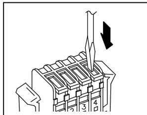
2. 接続する電線の被覆を剥ぎます。(撚線の場合は、挿入に備え軽くねじります。) コネクタキャップを電線にセットします。
