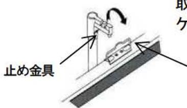
取手を持ち、止め金具から取手を外し、スクリーンをケースに収納します。
