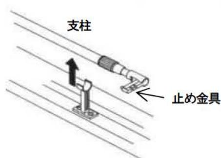
2-2. 止め金具を正面側にし、支柱をケース内部の固定金具に差し込みます。
