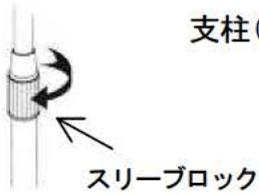
支柱(小)が完全に収納されたら、スリーブロックを右に回しロックします。
