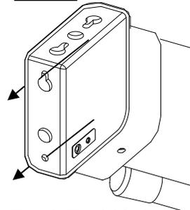
※付属の段付スペーサーを使用し、吊りボルト用取付穴での、付属ねじ(十字穴付きトラスタッピングねじ 4×30)固定も可能です。
