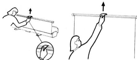
②最大高さまで引き出すには、背面にまわり、パンタグラフの動作位置を持ち、図のように押し上げてください。
