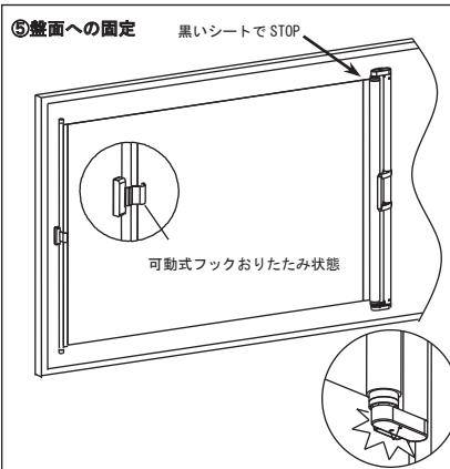
黒いシートまで引き出し、最後にブラケットのマグネットを盤面にしっかりと固定します。
