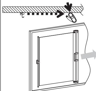
巻取りローラーを盤面に押し当てるながら、コロコロと転がすように横へスライドさせます。
