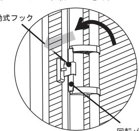
更にグリップを上げて回転させ、可動式フックから回転パイプを外します。
