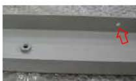
上フレーム<リンク取付穴>
