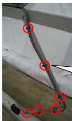
※フレーム下側 ケーブル固定例
