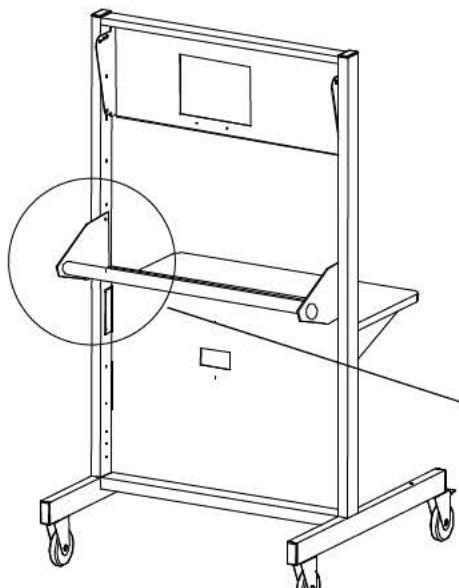
1. 平座金(樹脂)M14と移動用ハンドルをねじAで本締めします。
