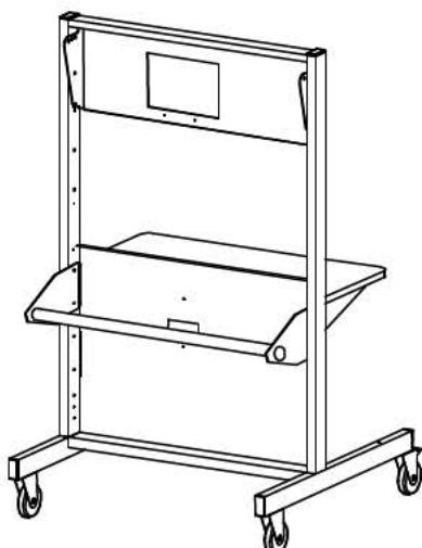
1. 一人が棚板を保持し、もう一人の作業者が棚板の上側の穴をねじAで仮止めします。(手締め)
