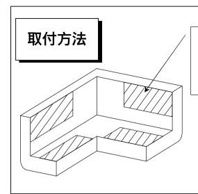
付属品の両面テープを保護カバー 裏側4点に貼り付けます。
