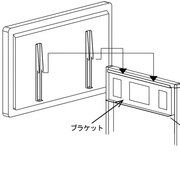
1. ディスプレイ取付金具を取り付けたディスプレイを二人以上の作業員で支え、メインフレームのブラケット上端にディスプレイ取付金具の溝を引っ掛けるようにして設置します。
