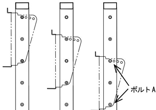
1. ブラケットとディスプレイ取付金具を固定しているねじ B を外します。
