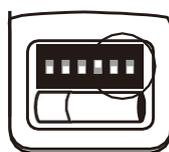
受信機のアドレスに合わせて、送信機のディップスイッチを変更すると、ペアリングは完了です。
