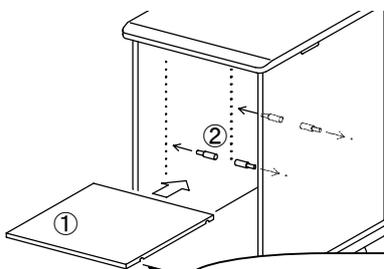
ダボ② 4個をラック左右の側板に差し込み、棚板①の切り込み部にあわせ、載せてください。
