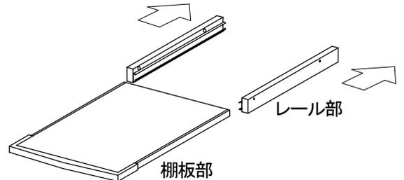
2. 左右のレール部をテーブル側板にある棚板用ダボ穴の希望の位置へタッピンねじ②各2本で取付けます。
